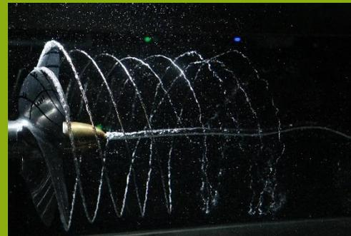
Spitzen- und Nabenwirbelkavitation an einem Schiffspropeller.
